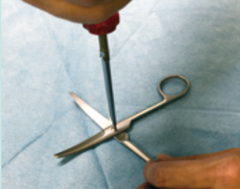
2枚の刃の接点をネジの締め具合で調整
