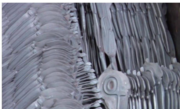
加熱した鋼をドロップハンマーを用いて成型
