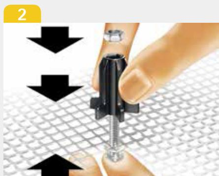
トレイの裏側から、図のようにネジを差し込み、リングハンドル保持用クランプを被せて、ナットで閉め込みます。
