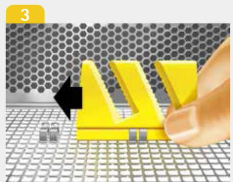
2つめの固定クランプも同様に取り付け、シリコンラックまたはシリコンホルダーをスライドさせ2つの固定クランプで固定して下さい。
